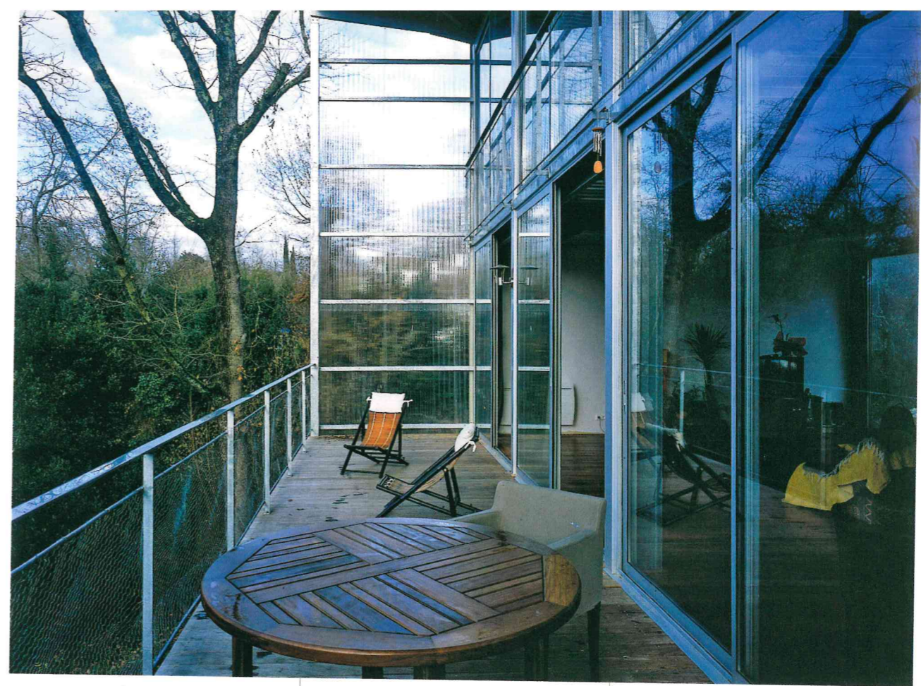
La terrasse dans l'axe nord-ouest. En hiver, lorsque les arbres ont perdu leurs feuilles et que le soleil est au plus bas, les apports solaires participent au chauffage de l'habitation. En été, le débord de la toiture et la végétation évitent au contraire le rayonnement direct du soleil sur le vitrage.
